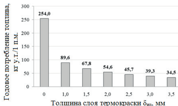
Магистральные трубопроводы в котельной (слева) и гистограмма годового удельного потребления условного топлива на примере природного газа (справа)
